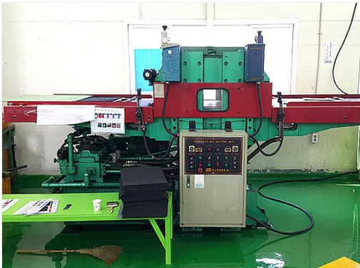
[튐슨 프레스] : 금형을 이용하여 치수정밀 부품 생산 장비
