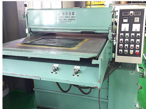
[튐슨 프레스] : 금형을 이용하여 치수정밀 부품 생산 장비
