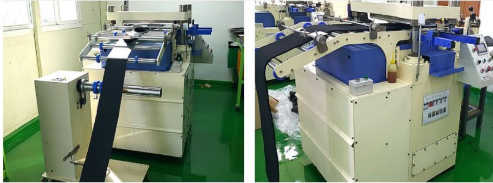
[씰링기(Sealing)] : 합지원단을 설계된 금형을 통해 자동으로 제품화
